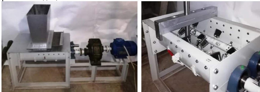
Рисунок 5. Экспериментальная установка двухвального смесителя со стержневыми элементами
